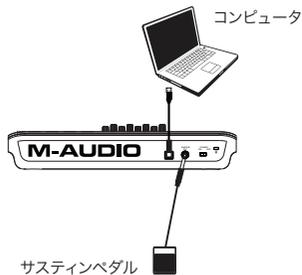
USB ケーブルで Oxygen キーボードとコンピュータを接続します。
