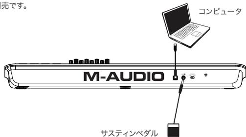
USB ケーブルで Oxygen キーボードとコンピュータを接続します。
